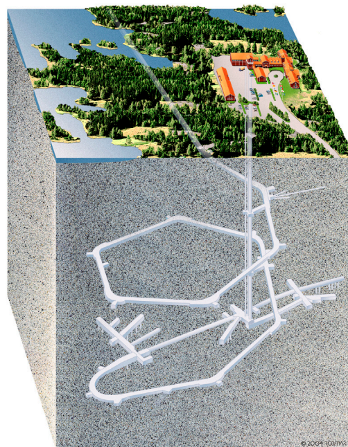
Figure 2 : Laboratoire sur la roche dure d'Äspö pour la recherche souterraine en Suède (avec la permission de SKB)
