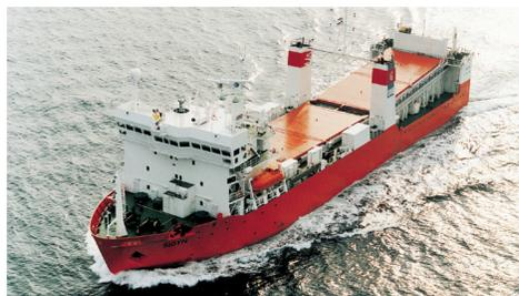
Figure 4 : Navire pour le transport du combustible irradié en Suède
