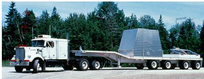
Figure 3 : Camion gros porteur pour le transport terrestre du combustible irradié
