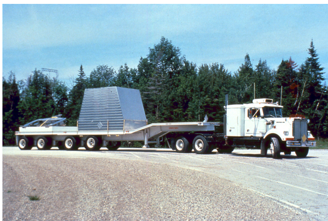
Figure 3 : Camion gros porteur pour le transport terrestre du combustible irradié : OPG
