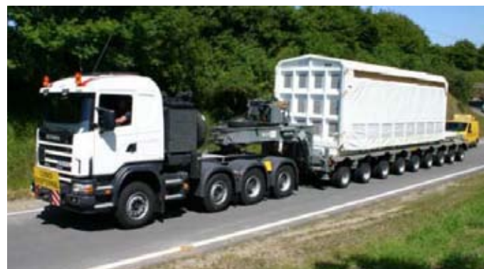
Figure 3 : Camions gros porteurs pour le transport terrestre du combustible nucléaire irradié : OPG (ci-dessus); Areva (à droite).
