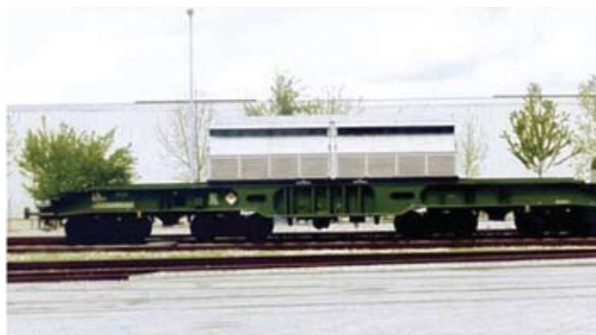
Figure 4 : Wagon portant un château de transport utilisé en Europe (à gauche); l'installation de transfert rail-route près de La Hague en France (ci-dessous). Photos : Areva.
