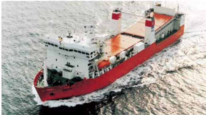
Figure 5 : Navire pour le transport du combustible nucléaire irradié en Suède (ci-dessus); chargement d'un château de combustible nucléaire irradié (à droite). Photos : SKB.
