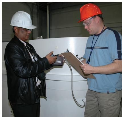
Figure 1 : Les conteneurs de stockage à sec d'OPG sont conçus de façon à recevoir des sceaux de garantie. Deux tubes séparés en acier inoxydable sont incorporés dans les parois, la base et le couvercle du conteneur et servent à fixer deux types différents de sceaux de l'AIEA.
