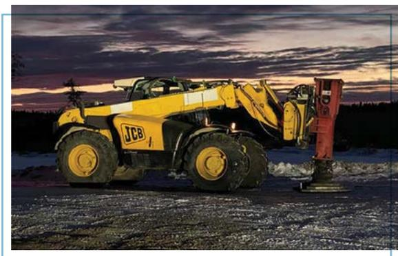
Un véhicule doté d'une source sismique réalise un levé sismique 2D dans la région d'Ignace.
