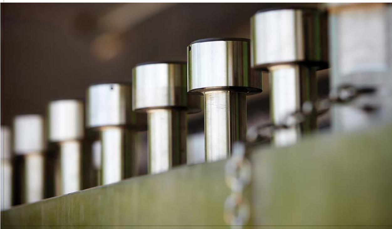
Trente-deux boulons sont insérés dans le Colis de transport du combustible irradié qui pourrait être utilisé pour acheminer le combustible irradié depuis les installations de stockage provisoire jusqu'au dépôt.
