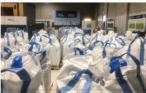
**En haut :** La SGDN a reçu de la bentonite brute à notre installation de mise à l'épreuve d'Oakville, en Ont., pour soutenir les essais de fabrication de blocs en bentonite hautement comprimée.
