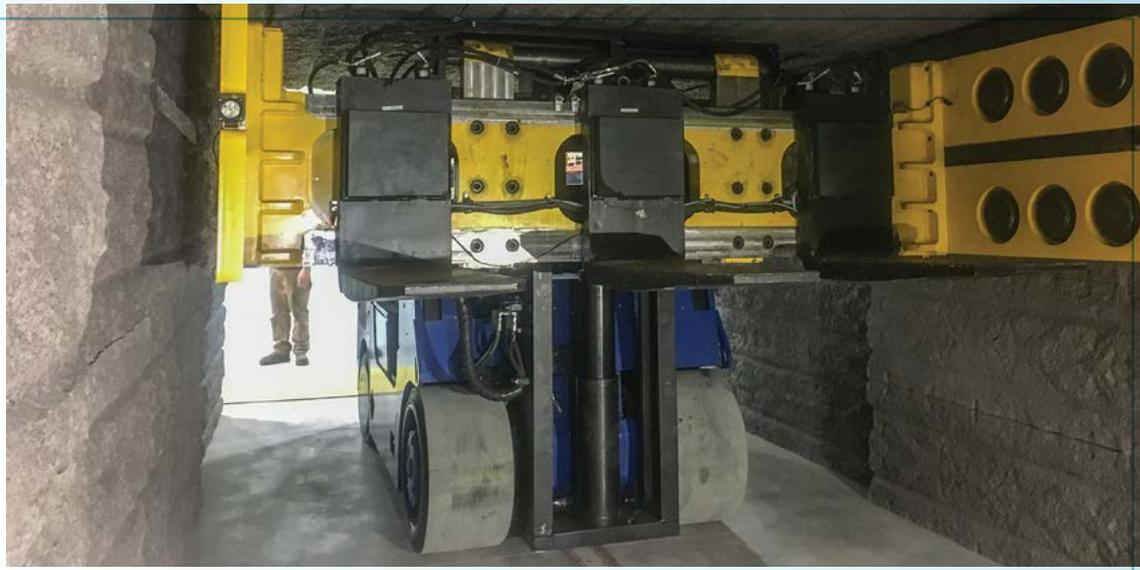
La mise à l'essai de la machine de mise en place dans une maquette de salle de mise en place confirme qu'il n'y a pas d'interférence à la hauteur maximale de levage.
