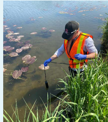
Un étudiant tient la pointe d'un limnomètre dans la rivière Teeswater. Le groupe a noté les mesures de divers indicateurs de la qualité de l'eau, notamment la température, la conductivité et l'oxygène dissous.
